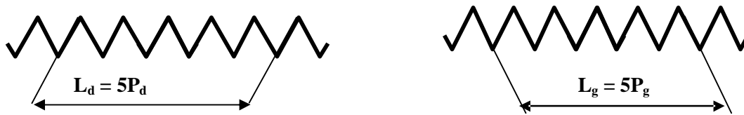
Contrôle de P sur le projecteur de profil
